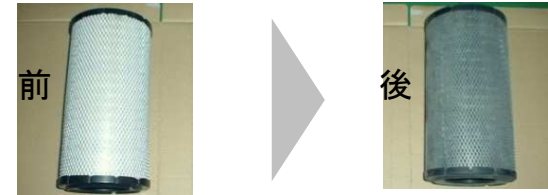
吸気フィルター清掃前後の状況
