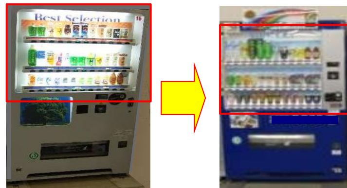
自販機照明の消灯事例
